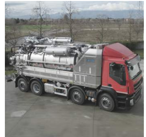
Allestimento VJC con due PVT1000 (140000 l/min)
