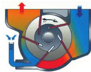
Raffreddamento ad iniezione: schema di funzionamento
