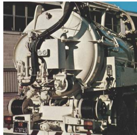
Complessivo posteriore di un allestimento VAC-JET
