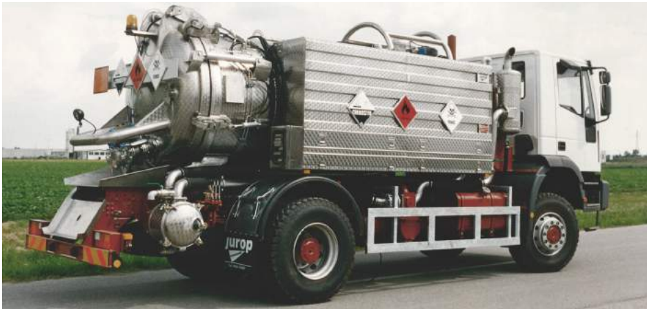
Un esempio di allestimento ADR
