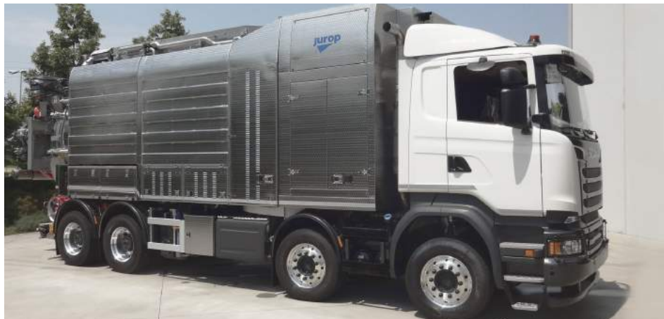
Attrezzatura per l'aspirazione e il trasporto di liquidi e liquami provenienti dallo spurgo di pozzi neri
